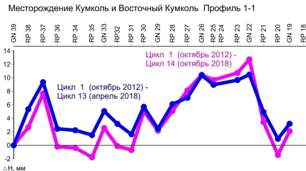
5 Сурет – 1-1 профиль бойымен жер бетінің вертикаль қозғалыстарының графигі
